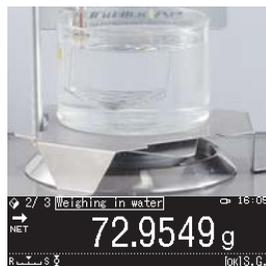
Dann folgen Sie der Anweisung auf der Anzeige und legen die Probe in die Flüssigkeit.
