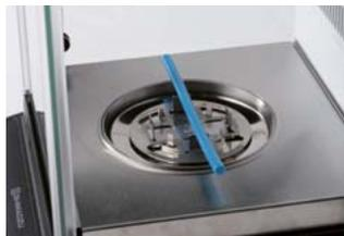
Längliche Meßobjekte lassen sich leicht und stabil in dem Multihalter platzieren
