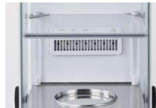
Der interne Windschutz minimiert den Einfluß von Windbewegungen innerhalb der Wägekammer und erhöht darüber die Stabilität der Messungen. (Optional erhältlich)
