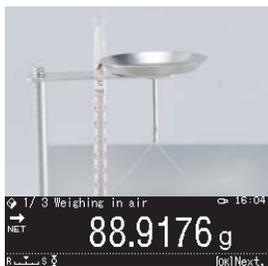
Als Erstes wird die Probe an der Luft gewogen.
