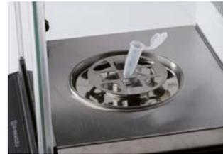
Einpipettierungen in Reaktionsgefäße lassen sich komfortabel über dem Multihalter realisieren.
