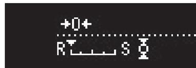
Verändern Sie die Stabilitätseinstellung nach links wird das Ansprechverhalten der Waage beschleunigt (Responsetime), wird die Einstellung nach rechts verlagert wird die Stabilität der Waage präzisiert. 5 Einstellungsstufen sind verfügbar.
