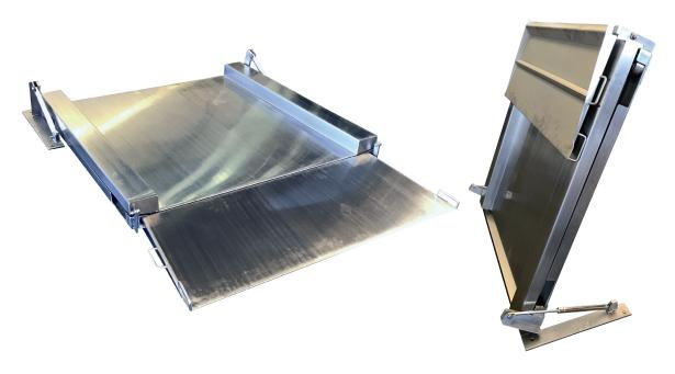
Diese Durchfahrwaage ist eine **vollständig klappbare** Konstruktion **mit sehr niedriger Bauhöhe**, komplett aus Edelstahl AlSl304 (oder AlSl316 auf Anfrage), mit vier nach IP68 oder IP69K geschützten DMS-Wägezellen, die durch einen Anschlusskasten verbunden werden.
