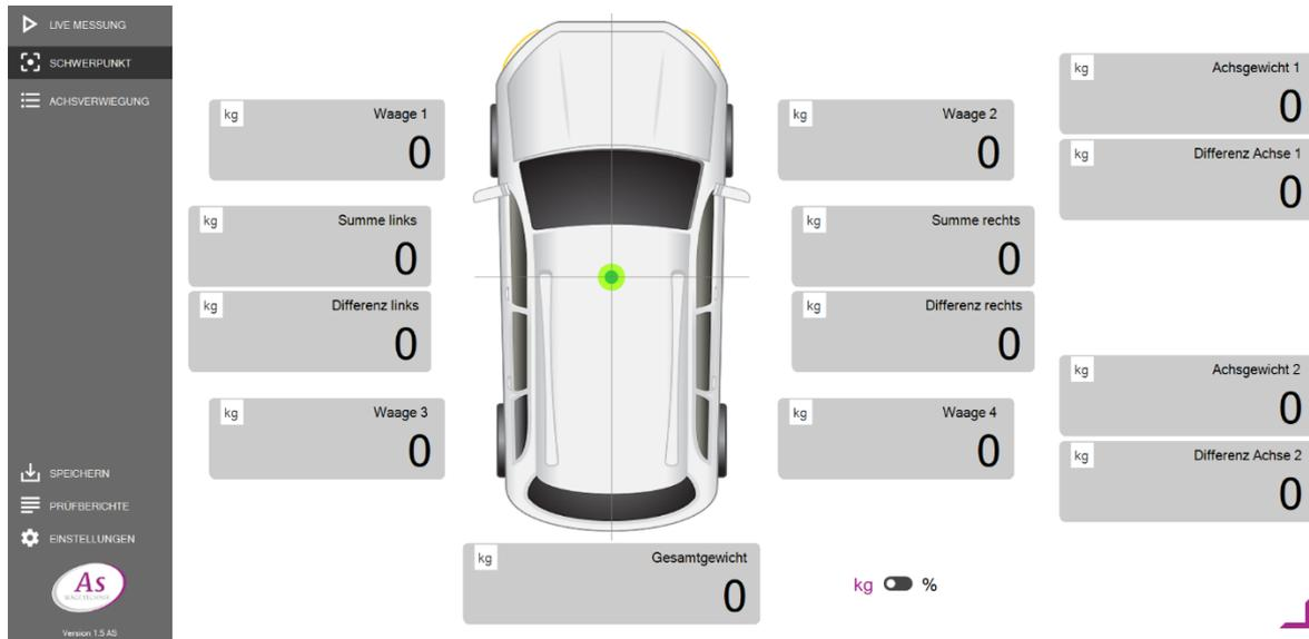
Die Windows-Software **AsCarSoft** ist ein umfangreiches Wäge-/Erfassungsprogramm für mobile Radlastwaagen der Serie AS-RLMF/As-MiGF sowie auch für stationäre Radlastwaagen, für verschiedene Branchen und Leistungsklassen. Die Software ist modular aufgebaut und kann ggf. kundenspezifisch erweitert/angepasst werden.
